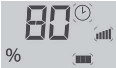
Schritt 2 des Firmwareupdate: Fortschritt wird in % angezeigt
