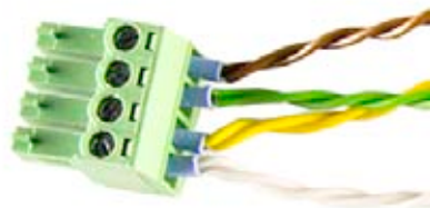
Abb. Detail Klemmleistenstecker mit Adernendhülsen
